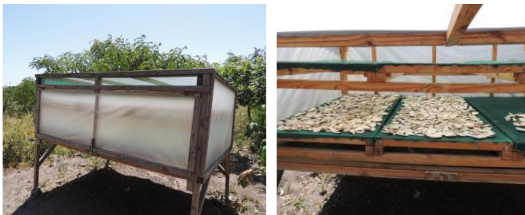
Figure 7: Sécher les produits alimentaires dans un grenier de séchage solaire en Tanzanie (Photo : D. Ofori)
